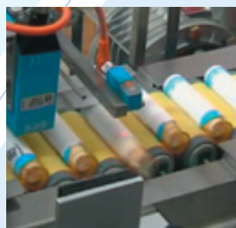
ITALY Controllo avvenuta etichettatura CS03-CS04-CS05 ENGLAND Label presence control CS03-CS04-CS05 FRANCE Contrôle étiquetage arrivé CS03-CS04-CS05
